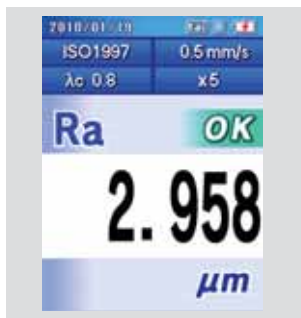
Zobrazení parametru Ra s vyhodnocením tolerancí
