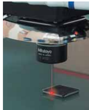
Koaxiální automatické zaostřování laserem (LAF - Laser Auto Focus)
