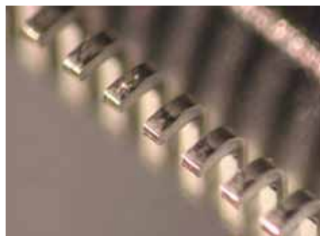
Příklad měření : Výška nožiček na QFP obalu
