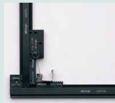
Ozubený hřeben, který umožňuje průchod světla. Pružinová část příruby zamykání v pozici pro měření.
