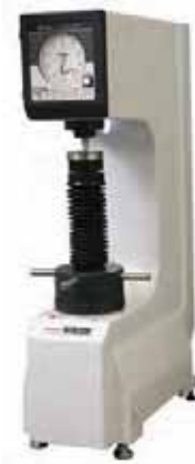
HR-210MR Tvrdoměr Rockwell Manuální změna závaží (s volbou celkového zkušebního zatížení) a ruční zkušební předzatížení. Motorické řízení kontroly pořadí zatížení.
